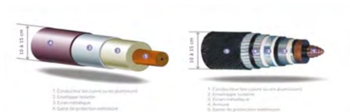
Figure 6 : Coupes des câbles souterrains et sous-marins
