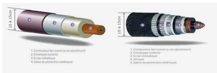
Figure 9 : Coupes des câbles souterrains et sous-marins
