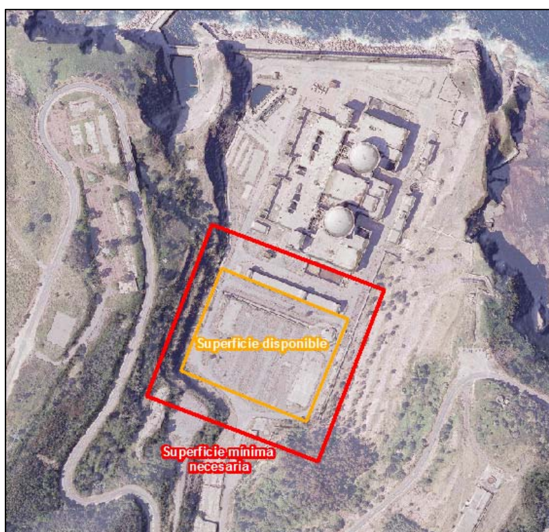
Figura 47. - Detalle de la superficie necesaria para la instalación de la Estación Conversora y de la superficie disponible en la Central Nuclear
