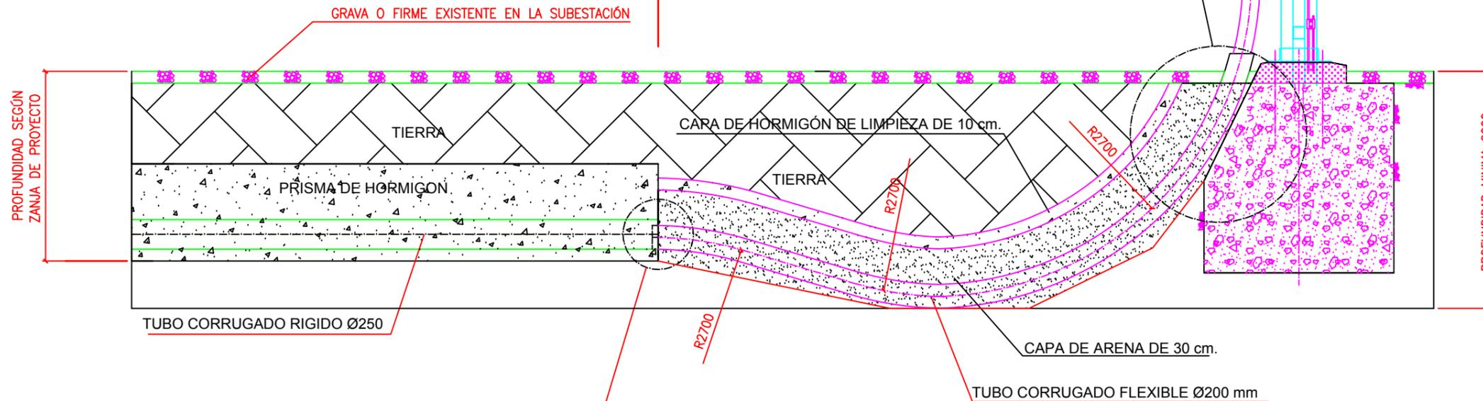
LA CONEXIÓN DEL TUBO FLEXIBLE Ø200 SE HARÁ INTRODUCIENDO 50 cm. EL TUBO DE Ø200 EN EL TUBO DE Ø250. DESPUÉS SE SELLARÁ CON ESPUMA
