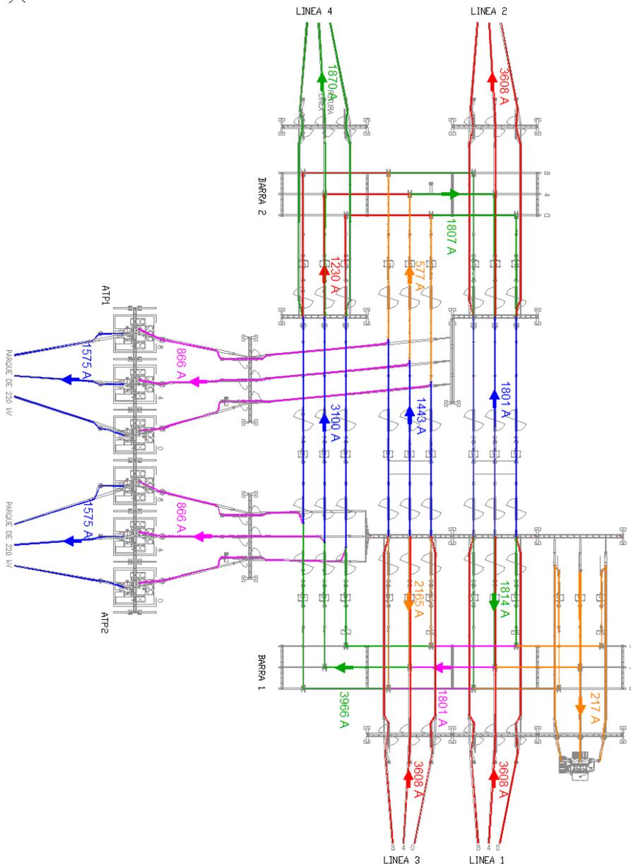
Fig 3: Intensidades estimadas para cálculo de campo magnético
