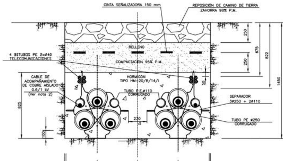
Para el tendido de los cables de potencia se instalarán por cada circuito 3 tubos de 250 mm para tendidos de 400 kV, en disposición al tresbolillo.
