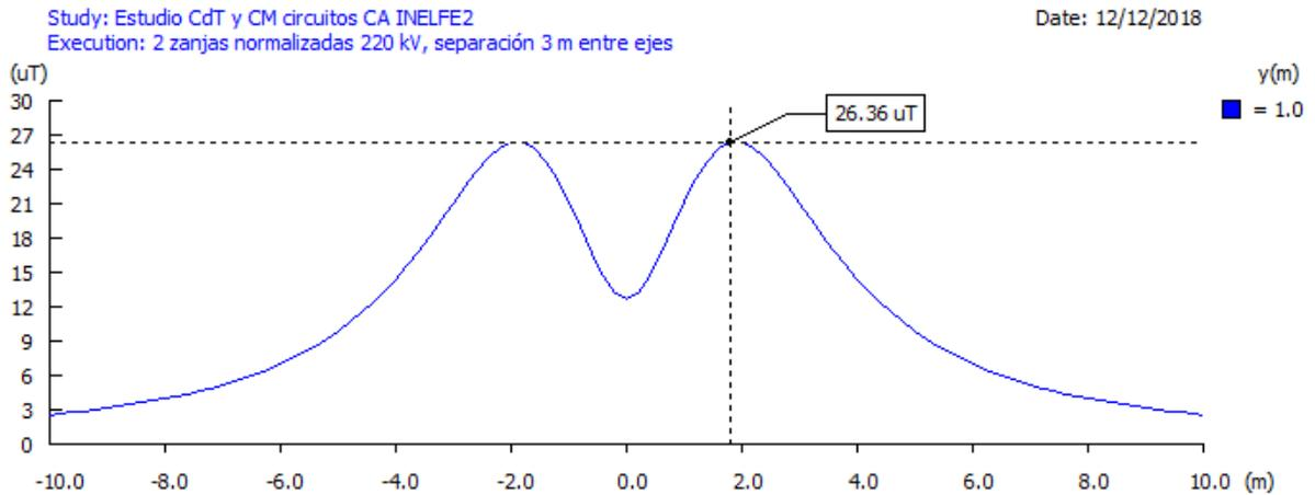
Figura 1. Valores de campo magnético a 1 m sobre la superficie del terreno (1.598 A – 1.107 MVA)
