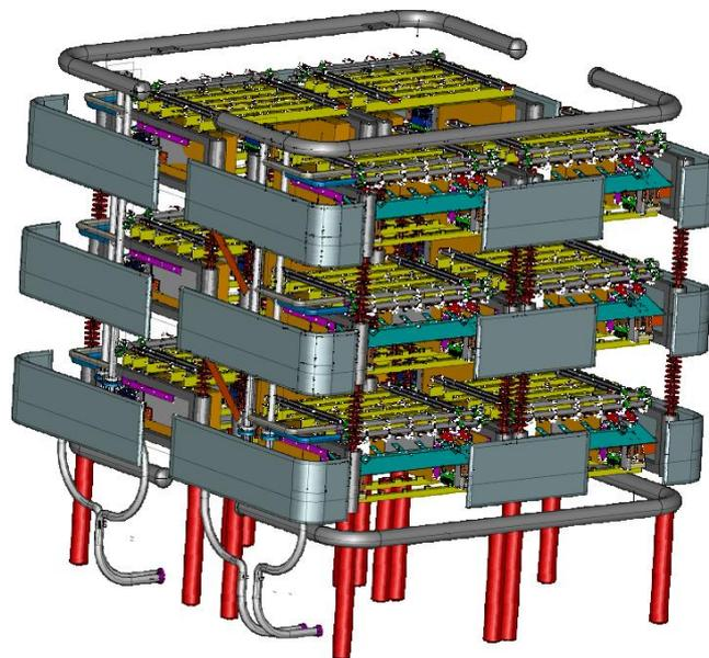
La refrigeración de los módulos de potencia se realiza mediante corrientes de agua desionizada y saturada de oxígeno, que fluyen horizontalmente a través de dichos módulos mediante pequeñas tuberías. Cada módulo está conectado en paralelo a las tuberías principales con el fin de asegurar una refrigeración con la misma temperatura del agua en cada unidad. Cada torre tiene su propio
