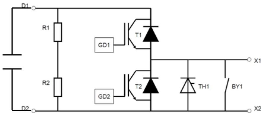
El **módulo de convertidor** es una cadena de módulos de potencia conectados en serie.
