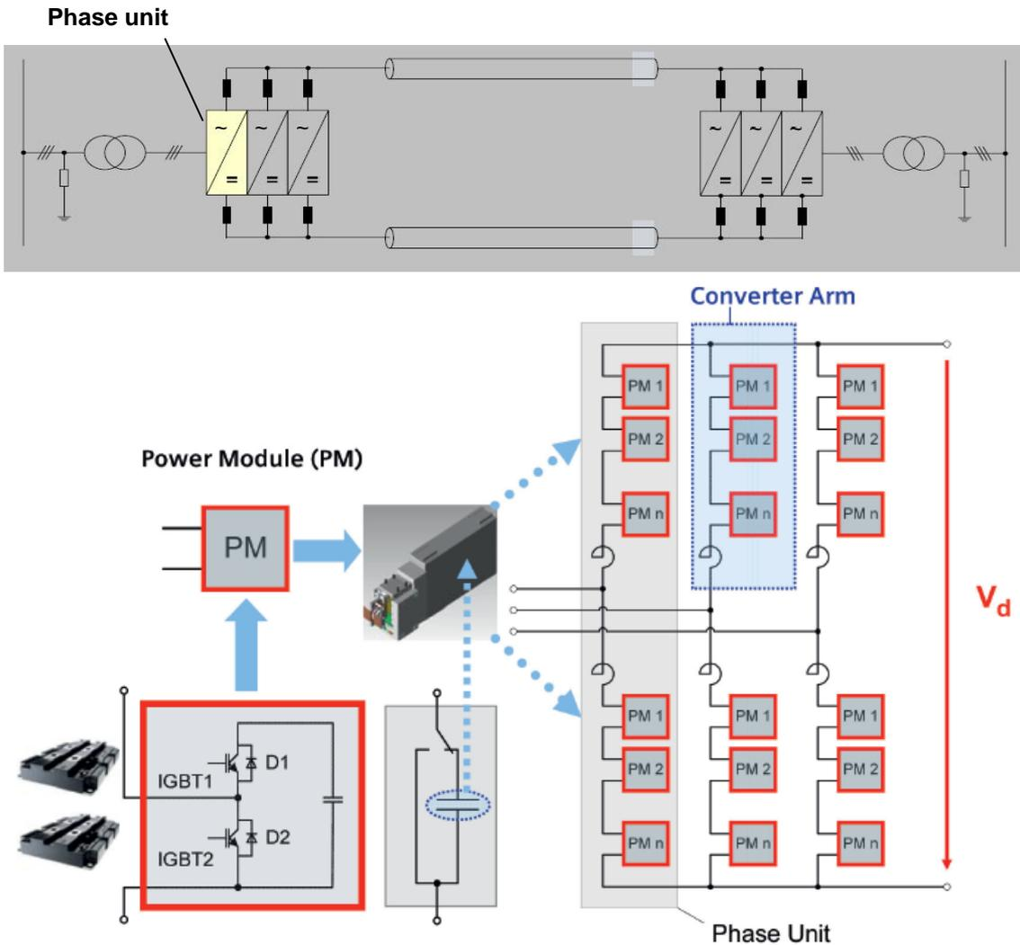
El **módulo de potencia** (detallado en la siguiente figura) está formado por dos transistores IGBT (*Insulated Gate Bipolar Transistors*), con los correspondientes diodos en antiparalelo (para conducción bidireccional de la corriente), además del condensador que mantiene el nivel de tensión necesario en cada módulo, resistencias, la placa de interfaz con la puerta del IGBT, interruptor de bypass y un tiristor de protección.
