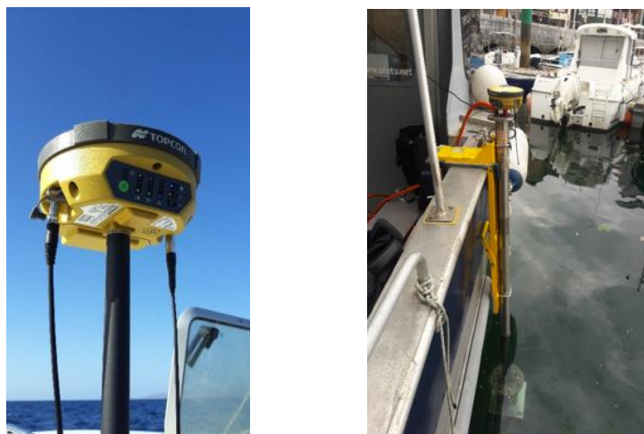
Figura 4. Izquierda: GNSS Topcon HyperV. Derecha: GNSS instalado en la misma estructura del transductor del SES 2000 para minimizar los offset del posicionamiento.
