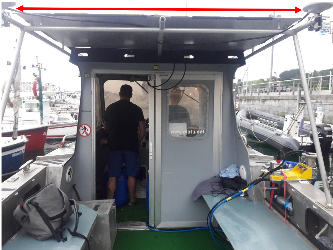
Figura 4. Posicionamiento de las antenas en el barco para la medida del rumbo verdadero.
