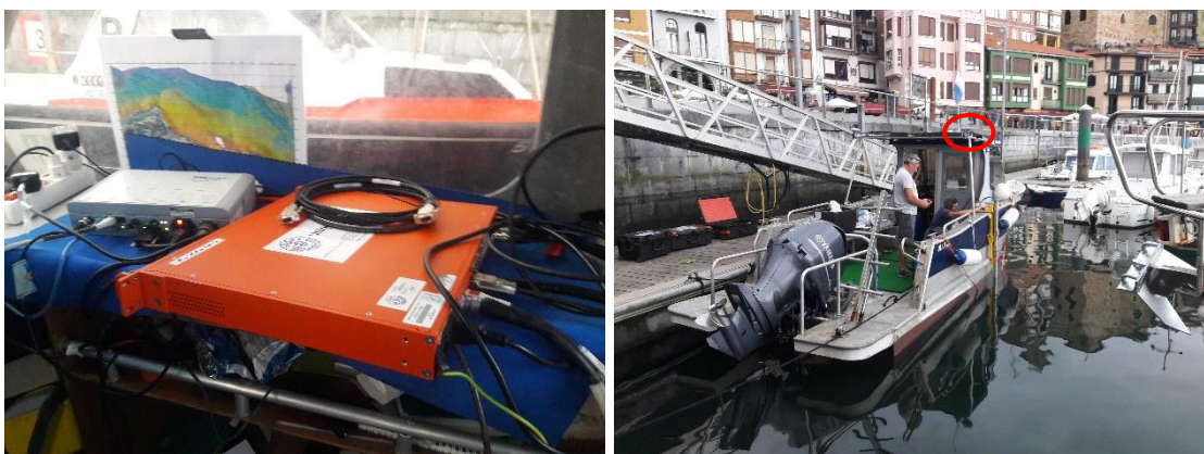
Figura 3. Izquierda: Sistema Navegación inercial GNSS I2NS. Derecha: Antena I2NS.
