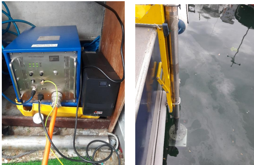
Figura 2. Perfilador Innomar SES-2000 compact. Izquierda: unidad de superficie. Derecha: transductor instalado en la borda de la embarcación OLATU.
