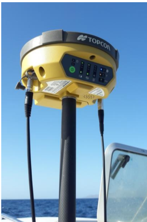
Figura 5. Sistema de posicionamiento GNSS. Topcon Hiper V.
