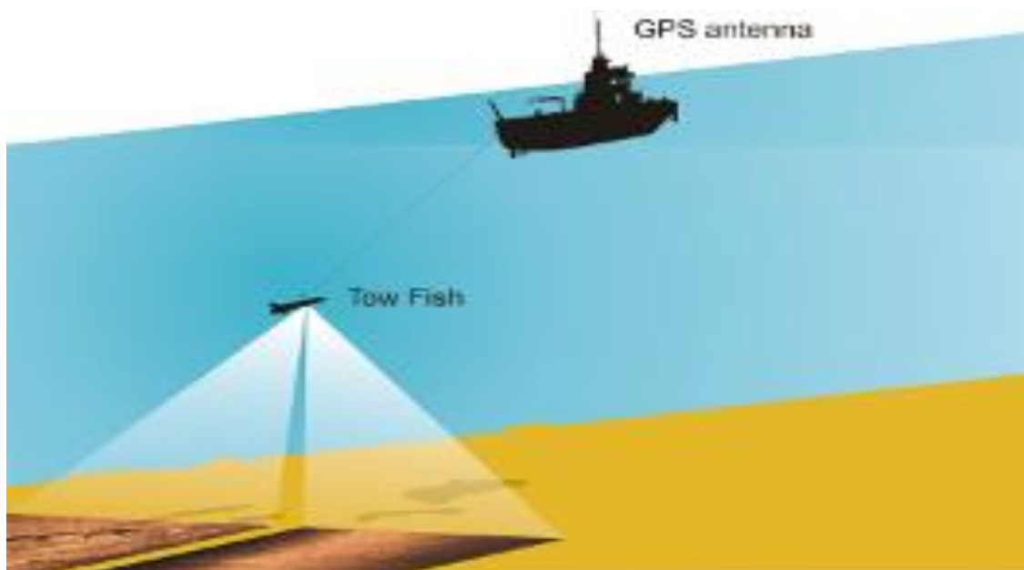
Figura 3. Imagen del “pez” remolcado por la embarcación.
