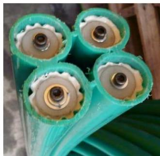
**Fig. 12: Colocación mandriles.**
