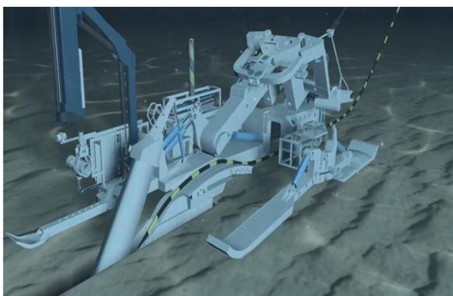
El *plough* es dirigido desde la superficie, siendo manejados los controles del aparato desde el barco con el apoyo de las cámaras de las que está provisto. La alimentación del equipo se realiza igualmente desde el barco de apoyo.
