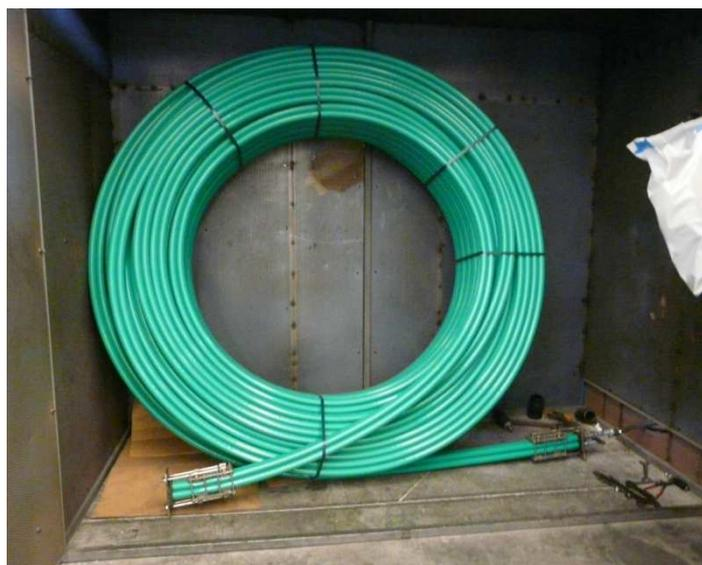
Fig. 8: Bobina de cuatritubo en interior de caseta de ensayo presión interna al aire.
