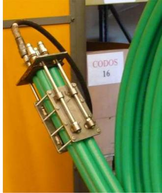
**Fig. 13: Tapón con válvula de inserción de aire.**
