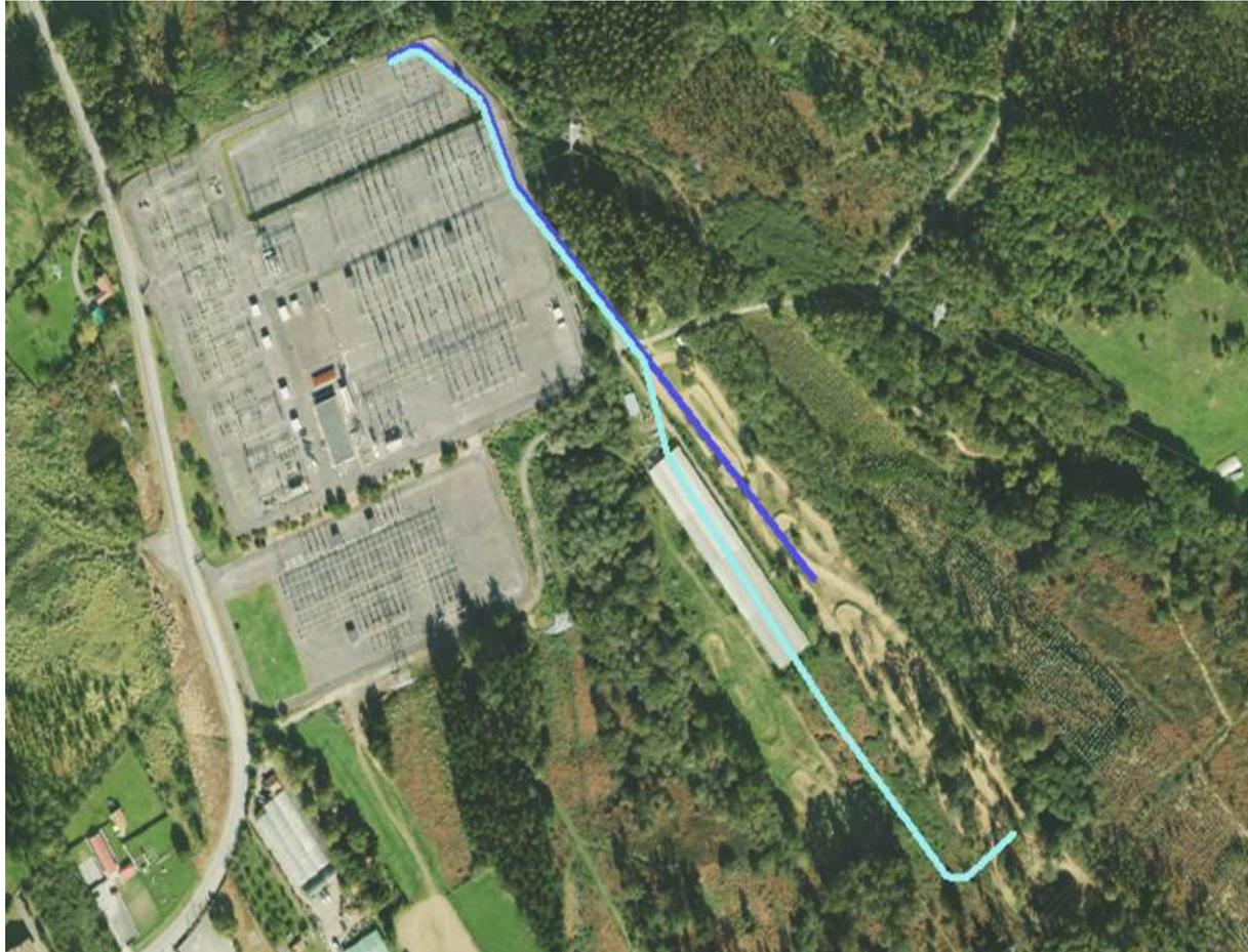
El trazado de la línea eléctrica de doble circuito subterránea a 400 kV entre la Estación Conversora de Gatica y la subestación 400/220 kV de Gatica en corriente alterna tendrá una longitud total de:
